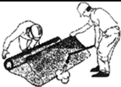
Наклейка расплавленного конца рулона
