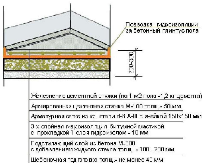
Рис. 11. Гидроизоляция пола подвала Защитная стяжка по слою бетона на полу подвала.
